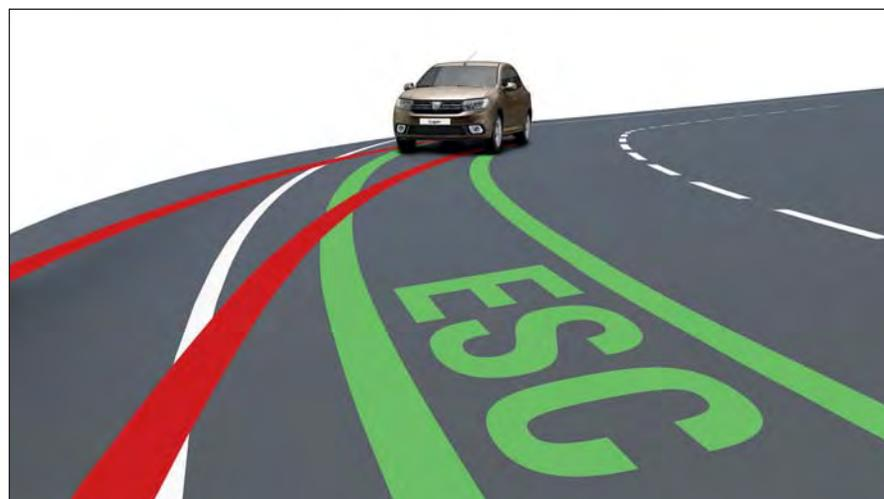
**ESC** : Il permet de stabiliser la trajectoire du véhicule en cas de perte d'adhérence dans les virages en agissant sur la répartition du freinage et le régime du moteur.
