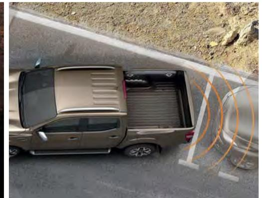
**Aide au parking arrière :** Pour faciliter les manœuvres de stationnement, le système d'aide au parking vous avertit des obstacles situés à l'arrière avec la caméra de recul qui affiche des lignes de guidage sur l'écran de navigation 7 pouces. Les capteurs arrière émettent une séquence de bips de plus en plus rapprochés en fonction de la distance, vous garer devient un jeu d'enfant.
