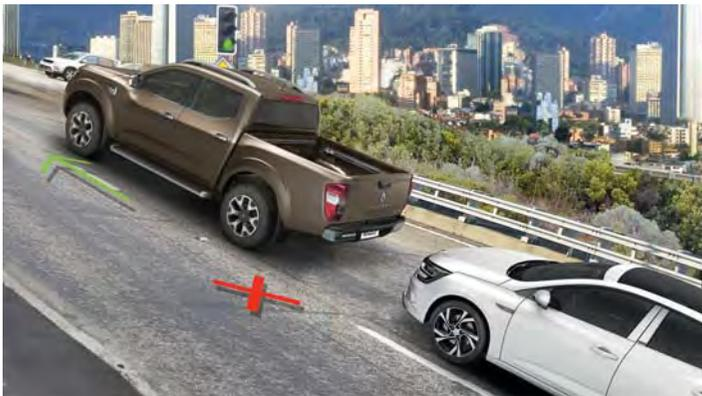
**Aide au démarrage en côte :** Lors d'un démarrage en pente, la pression de freinage est automatiquement maintenue pendant 2 secondes pour vous laisser le temps de manœuvrer sans risque de reculer.
