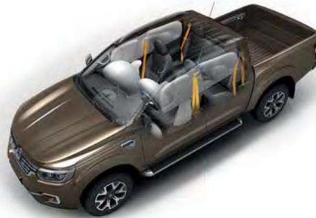
**Protection** : 7 airbags (2 frontaux, 2 latéraux, 2 rideaux, 1 genoux), ceintures de sécurité avec prétensionneurs, système ISOFIX pour fixer les sièges de vos enfants, structure de l'habitacle avec zones d'absorption des chocs, appuis-têtes anti-coup du lapin...
