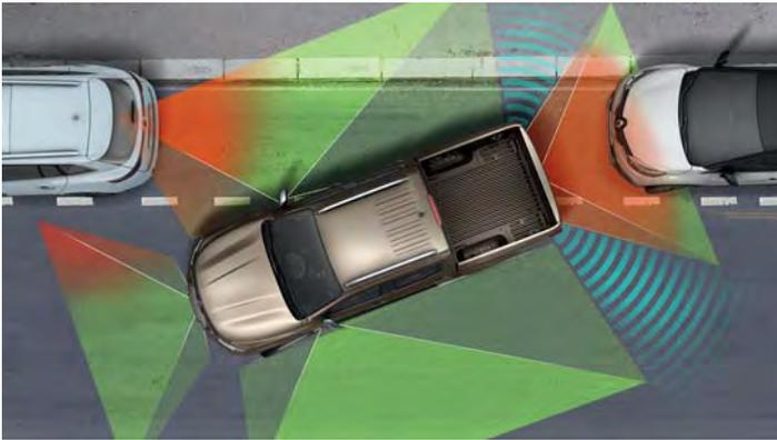
**Camera 360°** : Alaskan vous permet d'éviter les obstacles et vous offre une visibilité à 360° : 4 caméras sont installées sur le bouclier avant, les rétroviseurs extérieurs et la ridelle arrière. L'écran de la navigation intègre la caméra 360° avec une vision zénithale vous permettant ainsi de simplifier toutes vos manœuvres à faible vitesse.
